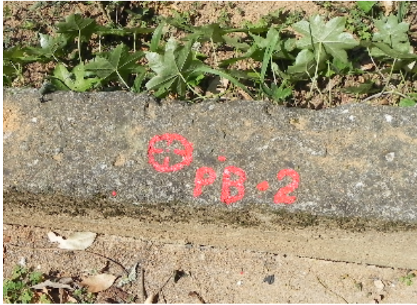
Figura 80: Marco utilizado na Seção 08 para determinação da cota da linha d'água e da geometria da calha do rio, acima do nível da água.
