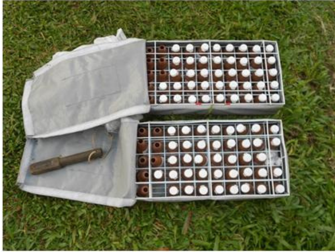
Figura 74: Porrete utilizado para fechamento das amostras e os engradados contendo as amostras coletadas em duas verticais na "Seção 02".
