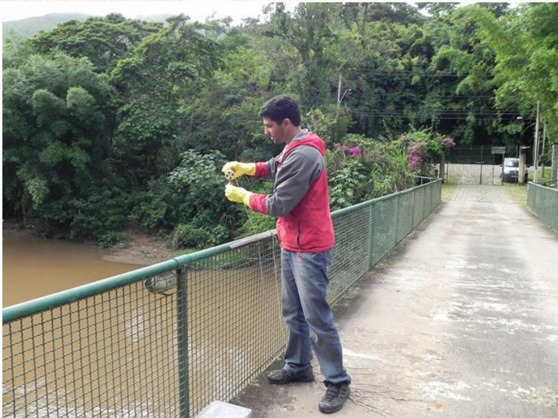
Figura 71: Momento da coleta da amostra de água e a transferência da mesma para o recipiente na “Seção 08”, respectivamente.
