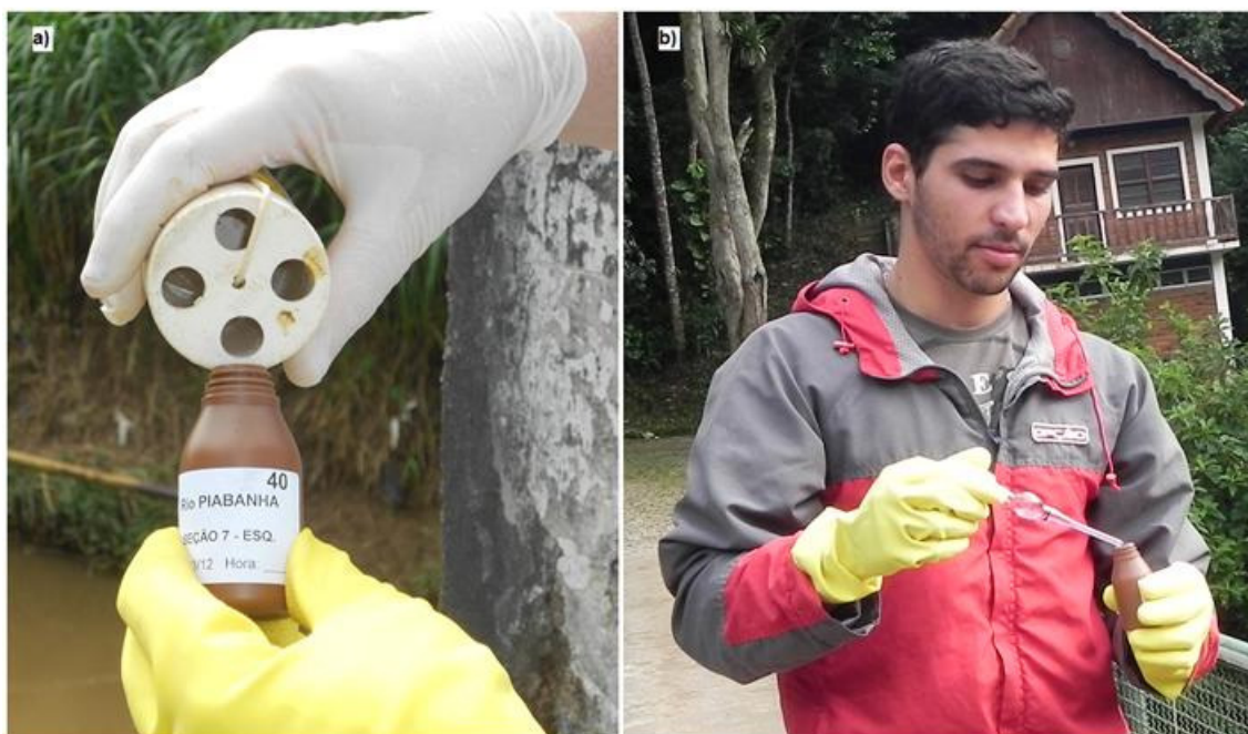
Figura 72: a) passagem da água coletada para o frasco devidamente identificado; b) Clorofórmio sendo adicionada à amostra.
