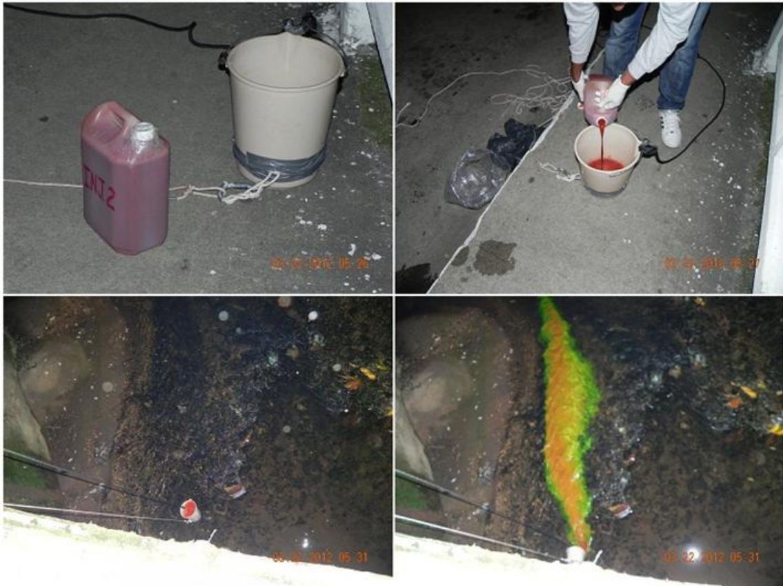
Figura 70: Fotos que ilustram o momento da injeção instantânea na ponte sobre o rio Piabanha próxima à confluência com o rio Avelá-Leman.
